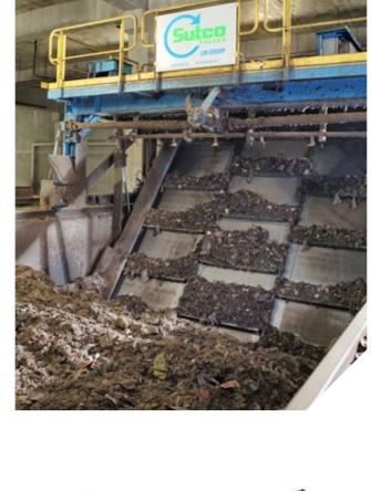
Die Umsetzmaschine BioFIX startet von dem Verfahrwagen aus und fährt über die Schienen auf den Zeilenwänden bis zum eingetragenen Material. Die Lösewalze der Umsetzmaschine BioFIX ist bis kurz über dem Lüftungsboden abgesenkt und fräst in das Rottegut. Dies wird aufgelockert, zerkleinert, homogenisiert
