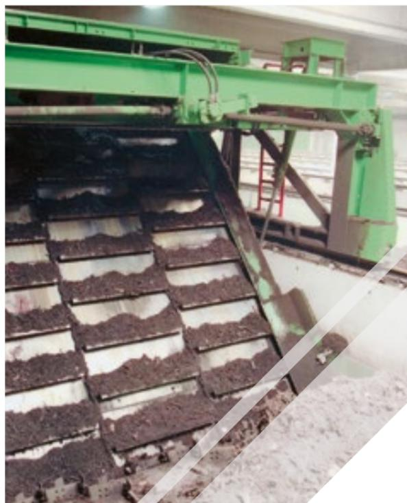
O material em compostagem é revirado e deslocado sete vezes ao longo do processo, acabando localizado na seção final da leira.
