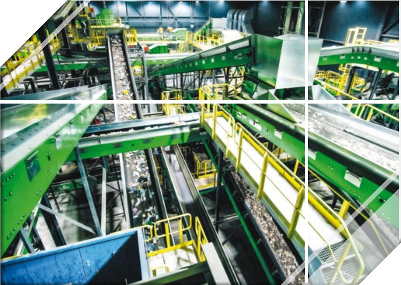
tierung der einzelnen Farben. Die 3D-Fraktion wird erneut einer optischen-pneumatischen Trennung unterzogen – die sogenannte NIR-Kaskade, die aus drei Materialfraktionen besteht: PET (aufgeteilt in 3 Farben), PE/PP und Tetra-Pack. Auch hier werden die Fraktionen zwecks weiterer Reinigung zur Sortierkabine geschickt.
