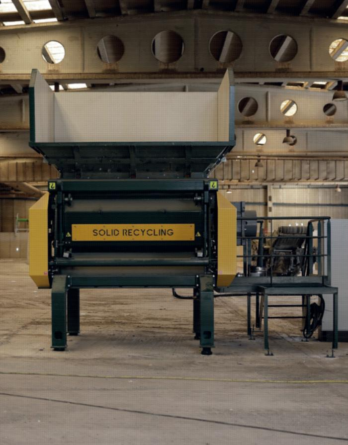
equipo instalado en una situación previa al trómel de cribado, y con una alta eficiencia de desgarro y apertura de bolsas cerradas, el rendimiento del trómel aumenta considerablemente, mejorando el cribado de materiales, recuperando de esta manera gran parte de materiales de pequeño tamaño y de carácter orgánico.
