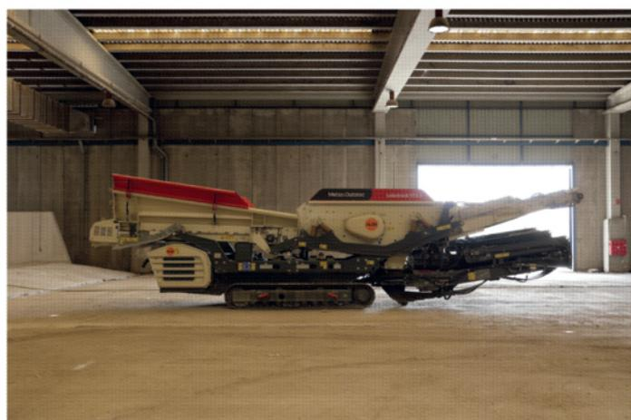
El triturador en cabeza de planta es el responsable de mantener un ritmo de alimentación adecuado dosificando el material en función de las condiciones de residuo que se esté alimentando, por lo que tiene la versatilidad de poder aumentar o disminuir el grado de desgarre (trituration) en el material a tratar y la capacidad de procesamiento en función de las revoluciones de su rotor, que son ajustables. Con este
