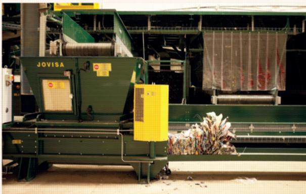
**PINCHABOTELLAS** de 1 x 0.8 x 0.68 m, construido con bloque mecánico Ch-8mm, Tambor conducido de 10 filas y 12 puntas con un diámetro de tambor de 27 cm. Tambor motriz de 11 filas de 12 puntas. Potencia  $2 \times 1,5 \text{ CV} = 2,2 \text{ Kw}$ . Regulación manual de abertura de 7 a 13 cm. Producción 1.600Kg/h que equivale a 34.000 botellas/h.
