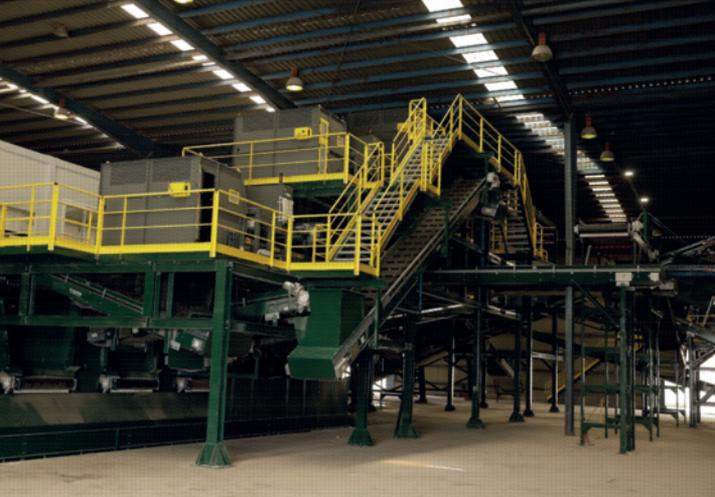
una cinta que conecta con la cinta de rebose del trómel de cribado, la cual entra directamente en la cabina de triaje secundario, con la finalidad de recuperar los materiales reciclables presentes en dicha fracción. El material no recuperado es dirigido hacia la prensa de rechazos de planta.
