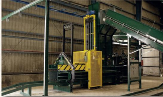
**UNA PRENSA EMBALADORA CONTINUA MOD. JS-800V/55 LAT** para el embalaje de subproductos, totalmente automática, con 1 motor de 50 CV, 55 Tn de fuerza, bala de 800 x 720, tolva de 1500 x 800 mm, pasado de agujas, atado automático de 5 hilos de alambre, pisón y control eléctrico con autómatas programables. Seguridades incorporadas según normas CE.
