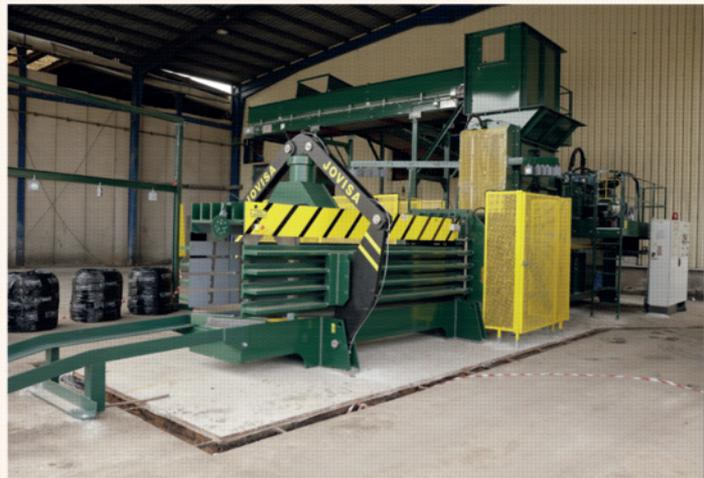
PANTALLA GRAFICA, con válvula electrónica, con ajuste electrónico de presiones y largo bala, control de producción, preselección de 20 calidades (a definir), códigos de control de producción y alarmas en pantalla.
